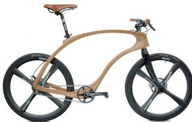
Rys.343. Rower Waldmaister - chyba najbardziej futurystyczny i najładniejszy z całej „drewnianej rodziny”. Rama zbudowana jest ze sklejki a koła i przedni widelec mają w sobie sporą domieszkę węgla
