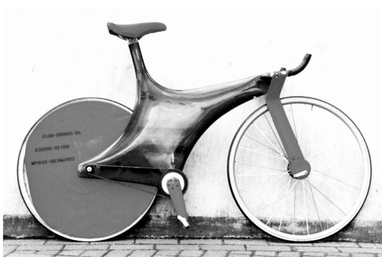
Rys.329. Rower wyścigowy z karbonową ramą, projekt Mike’a Burrows’a
