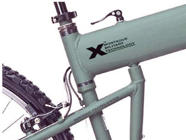
Rys.155. System łączenia rurek w ramie Paratrooper'a
