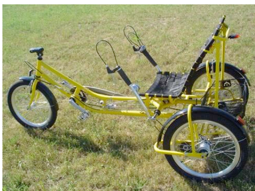
Rys.300. Rower rehabilitacyjny poziomy sterowany za pomocą drążków kierowniczych
