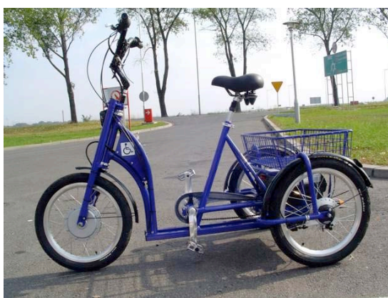
Rys.297. Rower trójkołowy z dwubiegowym silnikiem elektrycznym
