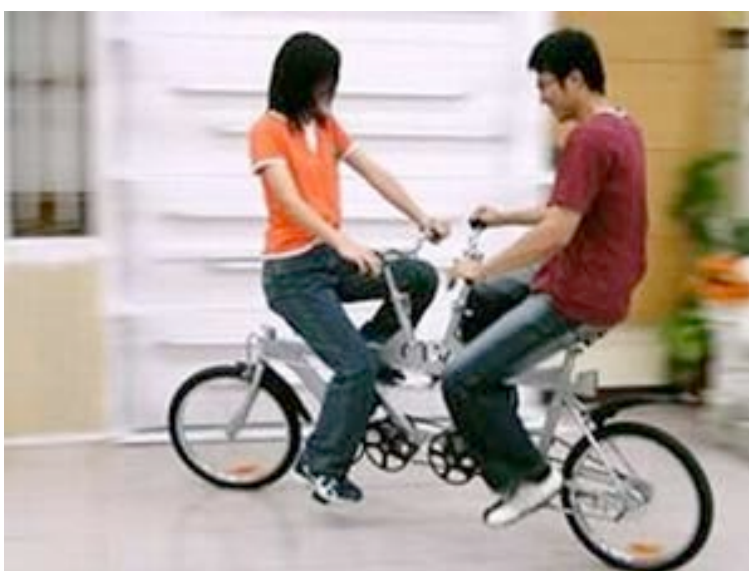
Rys.323. Nowoczesny tandem projektu Chen'a Yugang'a (3 sposoby siedzenia: klasyczny, plecami do siebie lub twarzą w twarz)
