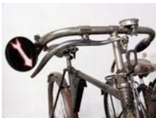
Rys.105. Rowerowy kierunkowskaz w formie blaszanej tarczy. Krzyk ówczesnej mody jak i sposób na przyciągnięcie klienta. Rok 1900
