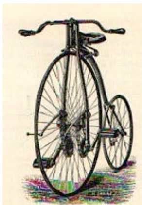
Rys.53. „Kangur” z napędem dwułańcuchowym
