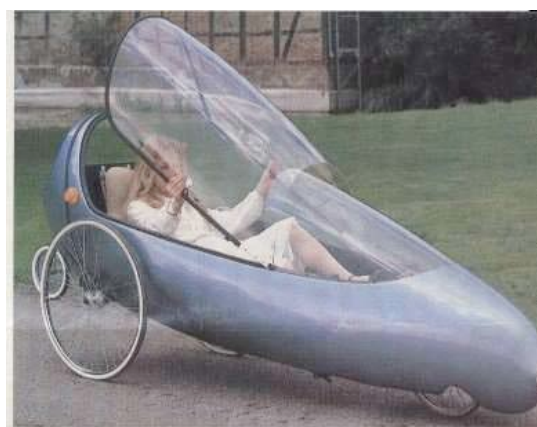
Rys.238.,239. Cyklomobile, czyli rowery z osłonami aerodynamicznymi
