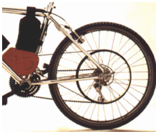
Rys.291. Rower z napędem elektrycznym za pomocą dodatkowego koła zębatego
