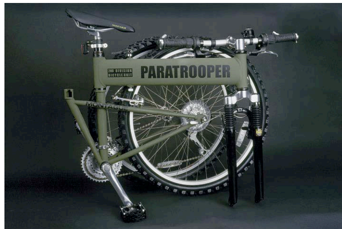
Rys.153.,154. Amerykański składany, spadochronowy rower wojskowy Paratrooper, zaprojektowany pod koniec XX wieku przez firmę Montague (składanie bez użycia dodatkowych narzędzi, zajmuje 30 sekund)
