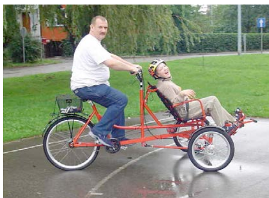
Rys.301. Tandem - rower rehabilitacyjny, w którym osoba niepełnosprawna siedzi w fotelu z możliwością pedałowania
