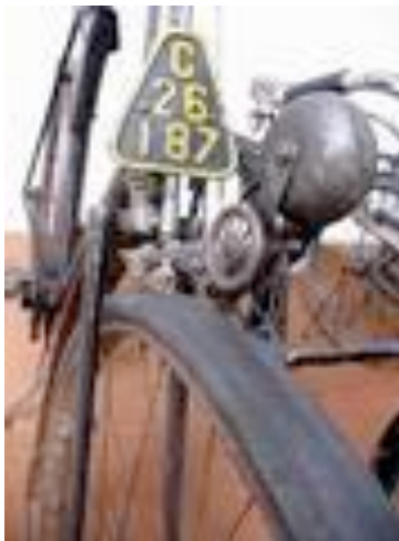
Rys.104. Dzwonek uruchamiany dźwignią dociskającą do przedniej opony kółko, które napędzało jego serce. Im większa prędkość, tym bardziej przeraźliwy sygnał. Turystyczny męski Naumann z 1900r.
