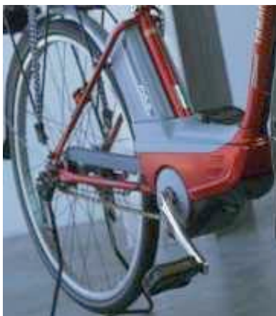
Rys.289. Pedal Assist System (PAS) - rower zintegrowany z elektrycznym systemem wspomagającym pedałowanie
