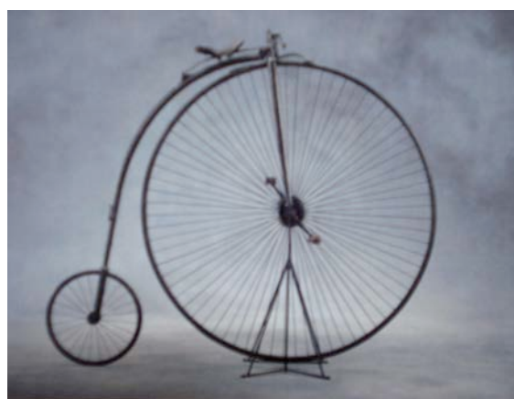
Rys.36. Bicykl z cienkimi metalowymi szprychami
