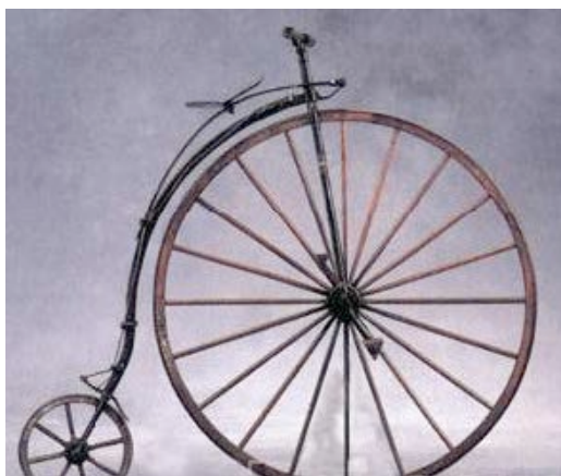
Rys.35. Bicykl z grubymi, drewnianymi szprychami
