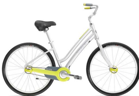
Rys.338. Rower z automatyczną skrzynią biegów (3-biegowy)
