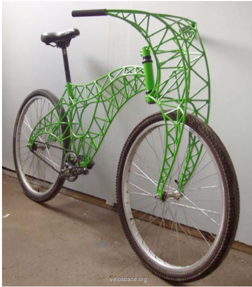
Rys.349.,350. Thick Art Bike – podobny do Arantix'a, ale ze wzgl. na materiał, mniej funkcjonalny
