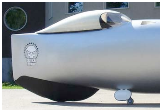
Rys.238.,239. Cyklomobile, czyli rowery z osłonami aerodynamicznymi
