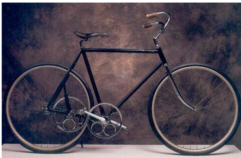
Rys.68. Ciekawe rozwiązanie kwestii napędu, Carroll Gear-to-gear, 1897r.
