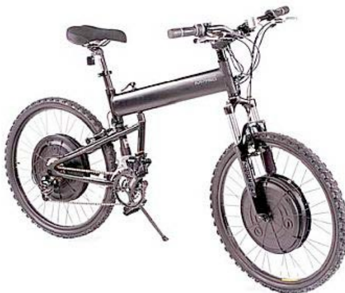
Rys.299. Rowery Tidal Force wykorzystują w tylnych kołach silniki WaveCrest o mocy 750 lub 1000W, pozwalające osiągnąć prędkość do 40 km/h. Akumulator NiMH zamontowany w przednim kole pozwala na przejechanie pomiędzy ładowaniami ok. 32 km
