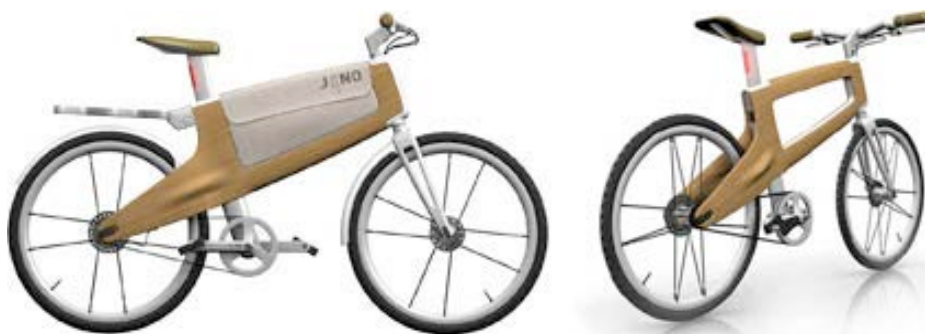
Rys.342. Rower Jano Ciekawe rozwiązania techniczne - pasek zębany zamiast łańcucha
