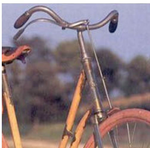
Rys.79.,80. Hamulec cierny w rowerze Chilion z 1898r.
